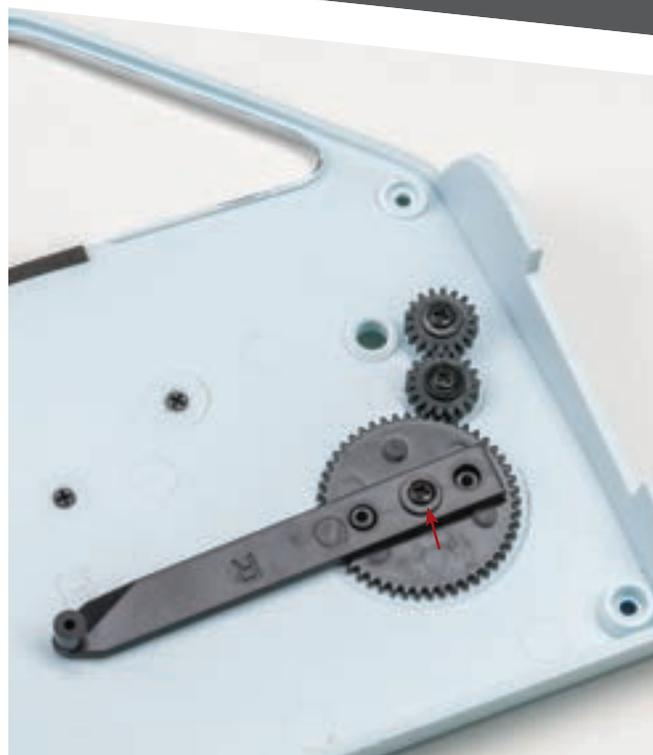
Совместите крепежные отверстия деталей. Обратите внимание: отверстия несимметричны, и детали совмещаются только в одном положении. Закрепите детали на оси обивки винтом 2,0×3 с пресс-шайбой (RP).
