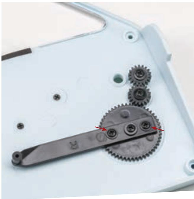
Зафиксируйте тягу стеклоподъемника на шестерне при помощи двух винтов 1,7×3 с пресс-шайбой (QP).
